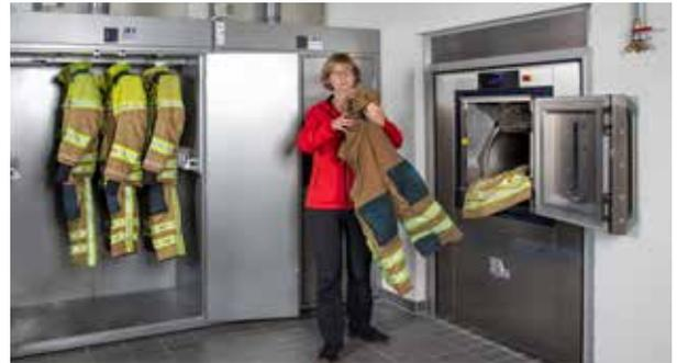
La seguridad del proceso incluye **programas de lavado claramente definidos** con dosificación automática de los detergentes. Como las lavadoras Línea 6000 poseen la **función Integrated Savings** con celdas de carga, el detergente se dosifica con precisión según el peso real de la carga.
